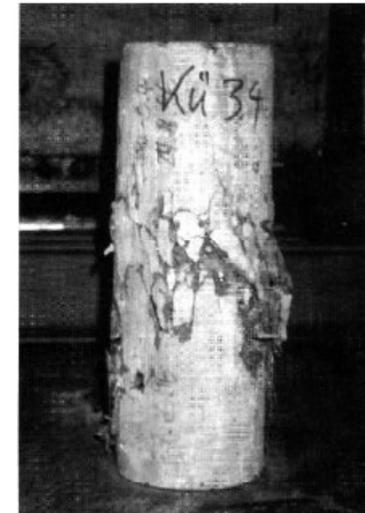
B7: Bruchbild von sprödem hochfestem Beton C 70/85 ohne und mit Fasercocktail, Quelle 2
